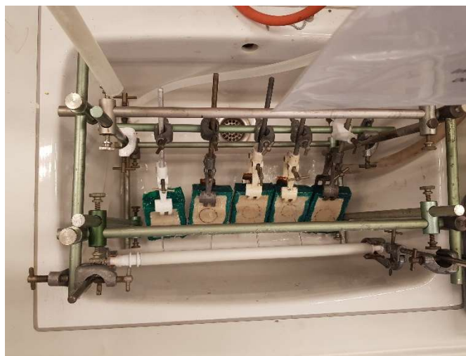
Foto links: Gesimuleerde regen op gecoate zandsteen monsters.
