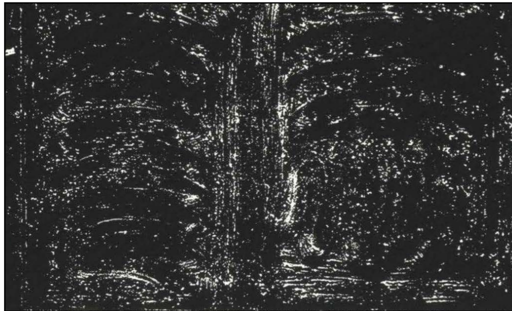
Figuur III.2.d: De vloer na reinigen met vlakmop a-nat
