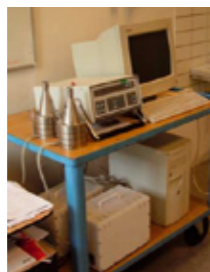
De meetkar, met onderin pompen en PC en bovenop twee monsternemers voor bacteriën en schimmels (RVS) en een deeltjesteller, naast de monitor.
